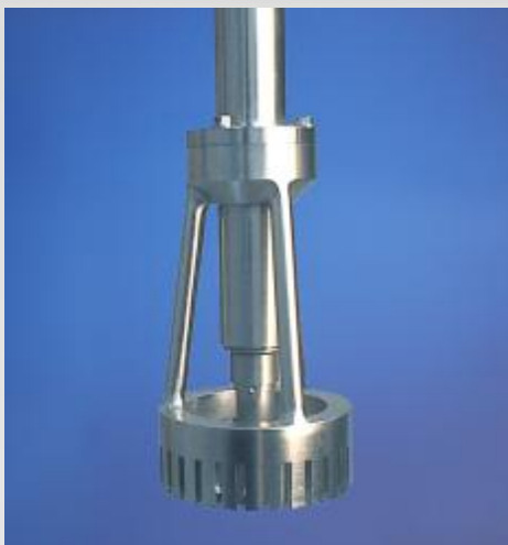
Disperseur pour montage au-dessus de la cuve, sur une traverse ou une bride du couvercle. La meilleure efficacité de dispersion est obtenue quand la machine est montée décalée par rapport à l'axe de la cuve
